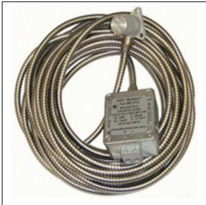
Вибропреобразователь «ВК-312» с выносной электроникой зарегистрирован в Государственном реестре средств измерений. Измеряемый параметр: мгновенное значение виброскорости в рабочем диапазоне частот. На выходе формируется выходной сигнал переменного тока, пропорциональный мгновенному значению виброскорости. Маркировка взрывозащиты: 0ExiaIICT5 x.
