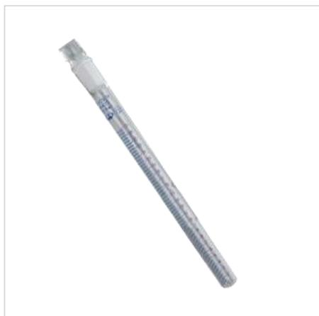
Стеклянные мерные пробирки со шлифом укомплектованы притертой пробкой. На поверхность, по всей длине, нанесена хорошо читаемая градуировка, выполненная ярким цветом. Допустимая погрешность соответствует цене деления, применяемой для шкалы.
