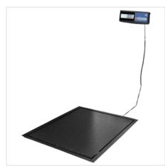
Весы 4D-PMF-12/10-A состоят из взвешивающего модуля 4D-PM-12/10, рамы для приямка и весового терминала А. Весы оснащены интерфейсом RS-232 для обмена информацией с внешними устройствами.
