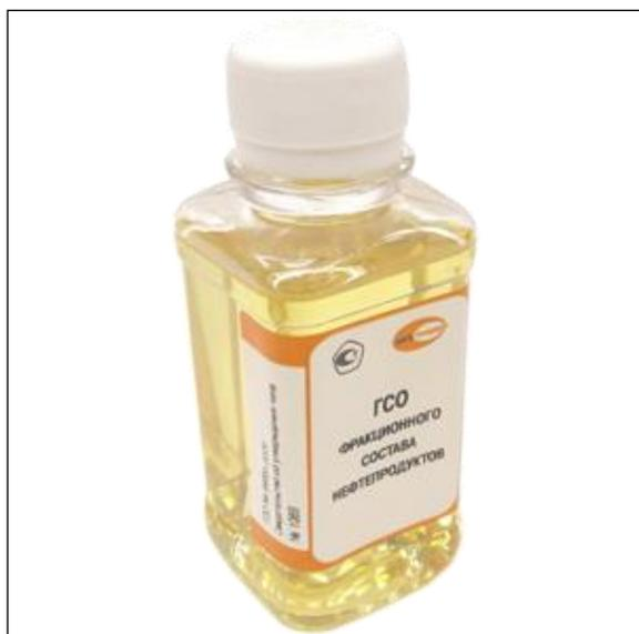
Стандартный образец предназначен для аттестации МВИ и контроля погрешностей методик выполнения измерений фракционного состава бензинов (ФС-Б-НС), реактивных топлив (ФС-РТ-НС) и дизельных топлив (ФС-ДТ-НС) по ГОСТ 2177-99 (метод А) и ASTM D 86.
