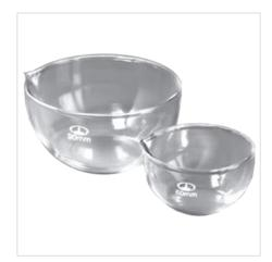
Стеклянные чаши ЧВП предназначены для выпаривания до сухого остатка жидкостей при температуре не выше +100°С в лабораторных условиях.
