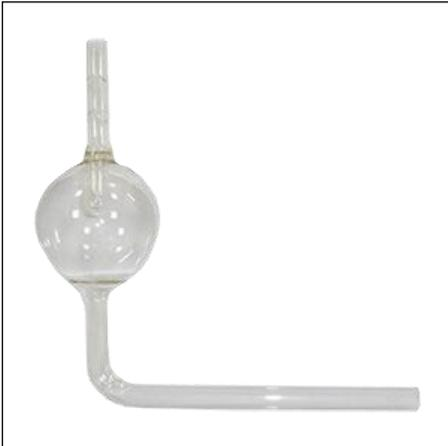
Специальный резервуар для сбора масла - масляную ловушку используют, чтобы избежать попадание вакуумного масла в откачную систему. Масляная ловушка изготовлена из стекла С52-1.
