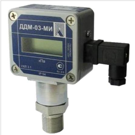
Датчик давлений ДДМ-03-МИ предназначен для преобразования избыточного давления (ДИ), абсолютного (ДА), разрежения (ДВ), избыточного давления и разрежения (ДИВ), разности давлений (ДД) в стандартный токовый сигнал 4-20 мА и отображения текущего значения на цифровом табло.
