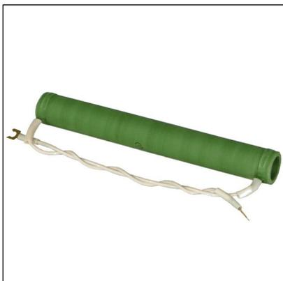
Согласующий резистор **СР** служит для применения в схемах проверки автоматических выключателей с помощью устройства «Сатурн-М», путем включения параллельно первичной обмотке нагрузочного трансформатора с целью обеспечения надежной работы узла регулирования тока устройства «Сатурн».
