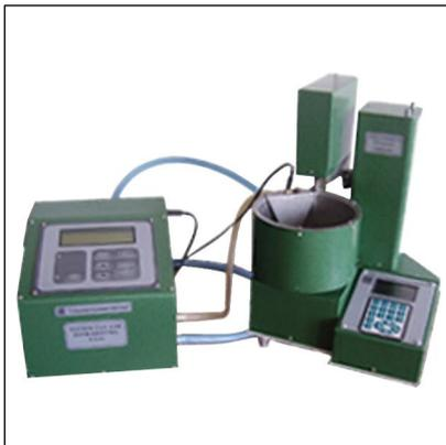
Пенетрометр универсальный **ПНУ-03** предназначен для определения пенетрации нефтяных битумов посредством автоматического измерения глубины погружения в испытуемый образец стандартной по массе, форме и размерам иглы (ГОСТ 11501) или конуса (ГОСТ 5346) при заданной температуре в течение заданного времени.
