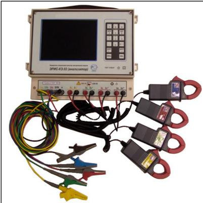
Переносной прибор для анализа показателей качества электроэнергии **ЭРИС-КЭ.02** предназначен для регистрации показателей качества электрической энергии (ПКЭ) в трехфазных (трех, четырех и пятипроводных) электрических сетях общего назначения. Подходит для работы в переносном режиме.
