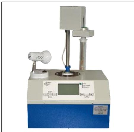
Аппарат АТКт-04 предназначен для определения температуры начала кристаллизации тосола и температуры начала кристаллизации химического продукта.
