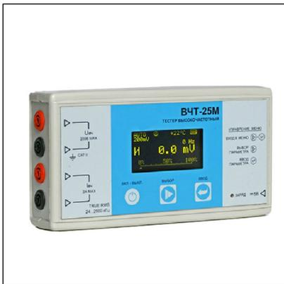
Высокочастотный тестер (ВЧ-тестер) **ВЧТ-25М** предназначен для измерений ВЧ токов и ВЧ напряжений в полевых условиях. Он может работать как отдельно, так и совместно со встроенным в РЕТОМ-ВЧ/64 магазином резисторов и конденсаторов. Прибор позволяет измерять напряжение, ток, частоту, полное сопротивление и полную мощность. ВЧ-тестер питается от одного Li-Ion (литий-ионного) аккумулятора. По своим точностным параметрам ВЧ-тестер сравним с вольтметром ВЗ-57.
