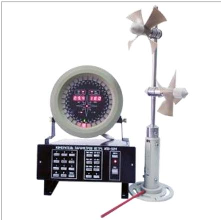
Измерители параметров ветра ИПВ-92М.02 предназначены для определения направления и скорости ветра.
