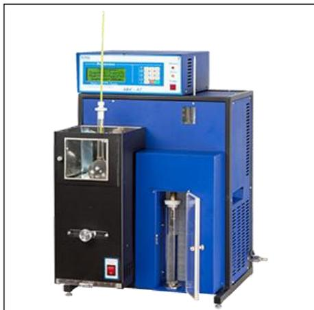
Аппарат АФС-02 предназначен для разгонки бензинов, керосинов, дизельных топлив и нефти в соответствии с требованиями ГОСТ 2177, ГОСТ Р ЕН ИСО 3405, ASTM D86.
