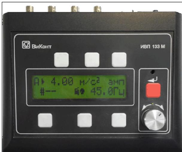
Блок предназначен для автоматизации процесса поверки и калибровки вибропреобразователей, вибromетров, вибродиагностических приборов и прочей аппаратуры, предназначенной для измерения и контроля уровня вибрации.
