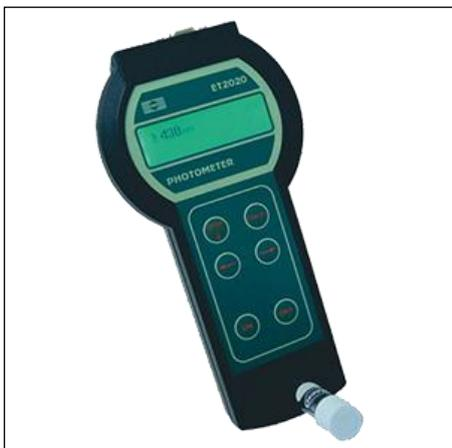
Анализатор ХПК «Экотест-2020-ХПК» предназначен для измерения ХПК по ГОСТ 31859-2012.
