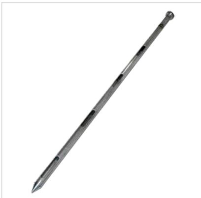
Ручные многоуровневые пробоотборники зерна служат для отбора средних проб в зернохранилищах, складах, автотранспорте, ж/д вагонах и т.д. Приборы позволяют отбирать пробы одновременно на нескольких уровнях при глубине насыпи до 1,5 м и до 2 м.
