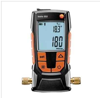
Testo-552 представляет собой цифровой вакуумметр для прецизионного измерения очень низких давлений в вакуумном диапазоне. Прибор позволяет контролировать разрежение (обычно в процессе ввода в эксплуатацию) в холодильных системах и в тепловых насосах.
