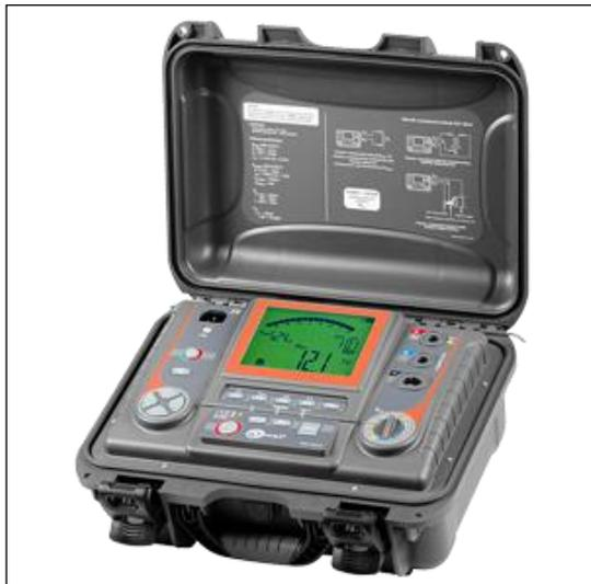
МІС-5010 предназначен для измерения сопротивления и всех основных параметров электроизоляции кабельных линий, трансформаторов, двигателей и других электротехнических устройств и телекоммуникационных установок измерительным напряжением до 5 кВ.
