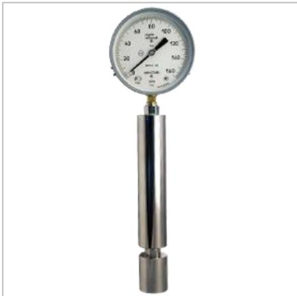
Бомба Рейда БР-010М предназначена для определения давления насыщенных паров нефти и нефтепродуктов с давлением насыщенных паров до 250 кПа.
