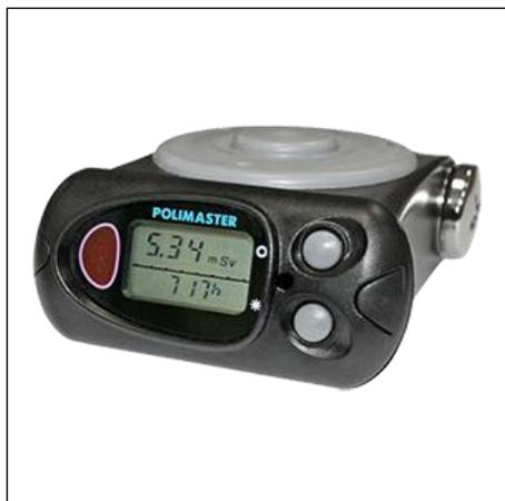
Предназначены для измерения индивидуальной эквивалентной дозы  $H_p(10)$  (ЭД) и мощности индивидуальной эквивалентной дозы  $\dot{H}_p(10)$  (МЭД) гамма и рентгеновского излучений в пределах от значений естественного фона до 0,1 Зв/ч (ДКГ-PM1621) и до 1 Зв/ч (ДКГ-PM1621А) в энергетическом диапазоне от 10 кэВ до 20 МэВ.
