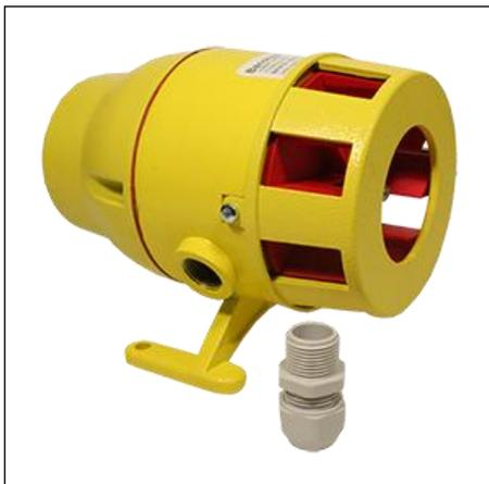
Сирены «BMDP» (Banshee Duplo) предназначены для подачи мощных низкочастотных аудио-сигналов в условиях производственных шумов. Корпус выполнен из алюминиевого сплава методом литья под давлением, позволяет монтировать сирену как внутри промышленных помещений, так и на открытых площадках. Наличие 2-х кабельных вводов в корпусе позволяет последовательно подключать несколько сирен.
