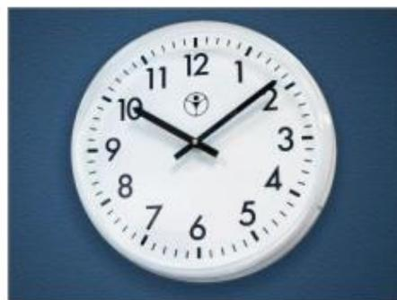
**СВ.ОМС.30. ДС24.Б.П.АЦ** Часы стрелочные вторичные односторонние с монтажом на стену, диаметр корпуса 30 см, управляются секундными импульсами чередующейся полярности с амплитудой 24В, цвет корпуса белый, стрелки прямые, разметка циферблата арабскими цифрами.
