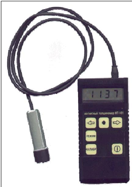
Магнитный толщиномер покрытий предназначен для измерения толщины немагнитных покрытий (хром, медь, краска, эмаль, пластик и т.д.) на ферромагнитном основании. Имеется режим "HOLD" - удержание последнего измеренного значения. Автоматическое выключение питания через 20 минут.
