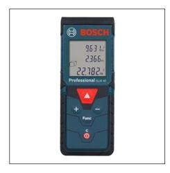
Лазерный дальномер GLM-40 — это лёгкий, компактный, простой в использовании прибор, позволяющий значительно повысить точность измерений и облегчит процесс их осуществления. Прибор позволяет определять расстояния от 5 см до 40 м с точностью до 1,5 мм. Таким образом, дальномер GLM-40 может эффективно использоваться помещениях и даже на строительных площадках.
