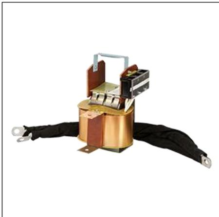
Малогабаритный трансформатор нагрузочный НТ-4 предназначен для испытаний токовых расцепителей автоматических выключателей и релейных защит первичным током при до 4 кА при их наладке и проверке. Оптимальная конструкция трансформатора позволяет значительно снизить нагрузку на питающую сеть при получении больших токов, а также создать компактное и относительно легкое устройство.
