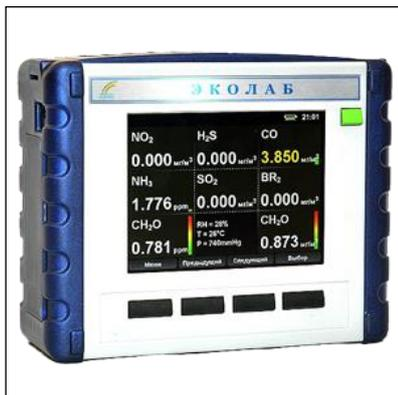
Газоанализатор ЭКОЛАБ предназначен для автоматического измерения концентраций вредных веществ в атмосферном воздухе, в воздухе рабочей зоны и в промышленных выбросах по выбору Заказчика, а также в технологических процессах в целях охраны окружающей среды, обеспечения безопасности труда и оптимизации технологических процессов.
