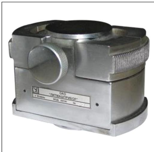
Предназначен для изготовления образцов формовочных и стержневых смесей, испытываемых на растяжение.
