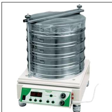
Вибростенд ПЭ-6700 предназначен для отсева сыпучих материалов.
