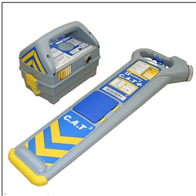
Трассоискатель **С.А.Т.3+ Genny3** состоит из локатора С.А.Т.3+ и генератора Genny3 и предназначен для обнаружения подземных коммуникаций. Локатор **С.А.Т.3+** позволяет обнаруживать пассивные "естественные" сигналы, которые обычно излучают подземные металлические трубы и кабели на промышленных частотах 50 Гц или на низких радиочастотах. Генератор **Genny3** может использоваться для подачи активных сигналов в линию так, чтобы их можно было обнаружить и проследить с помощью приемника локатора.
