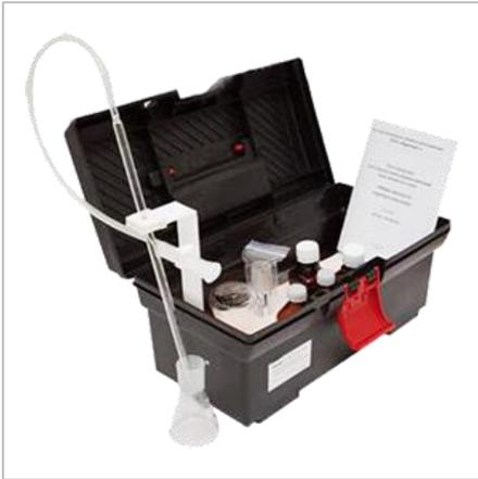
Тест-комплект «Окисляемость перманганатная» предназначен для определения массовой концентрации кислорода в питьевой и природной воде (ПНД Ф 14.2:4.154-99 (издание 2004г.)). Метод определения: титриметрический.
