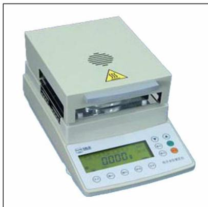
Влагомер MT-255 с галогенным методом сушки применяется для анализа влажности продукции. С помощью встроенных во влагомер высокоточных аналитических весов и современной технологии нагрева обеспечивается точный и быстрый анализ влажности. Работа анализатора влажности основана на гравиметрическом способе определения влагосодержания.
