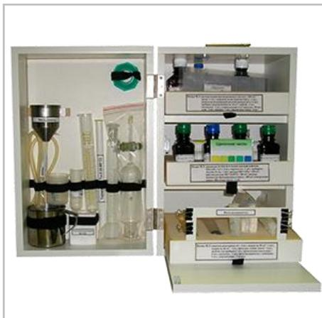
Судовая экспресс-лаборатория контроля топлив и масел СЛТМ-1 предназначена для контроля физико-химических показателей качества топлив и масел при эксплуатации силовых и энергетических установок на судах и береговых объектах (ГОСТ 11362-76, ГОСТ 3900-85, ОСТ РД 31.27.03-95).
