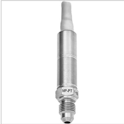
Тензопреобразователь MP-PT предназначен для пропорционального преобразования давления и температуры в электрические сигналы. Применяется в нефтегазовой промышленности, гидравлике, пневматике и насосных станциях/компрессорах. Контролируемые среды - газы, жидкости и их смеси не агрессивные к титановому сплаву (воздух, морская вода, пятипроцентная серная кислота, хлорная вода, растворы хлоридов, масла, ацетилен и т.д.)
