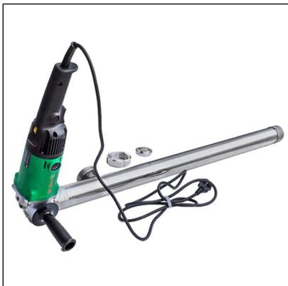
Бочковые насосные агрегаты **ОНЛб** предназначены для откачивания из глубоких ёмкостей (более 1,2 м) вязких слаботекучих пищевых жидкостей типа концентратов соков кинематической вязкостью не более 800 сСт. Диаметр горловины ёмкостей (бочек) должен быть не менее 70 мм.
