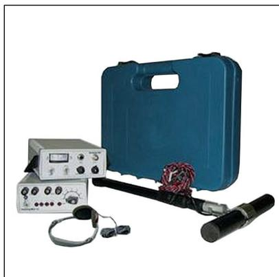
Индикаторный трассоискатель **ИККТ-50** предназначен для нахождения индукционным методом трасс металлических трубопроводов различного назначения, местоположения энергосиловых кабелей без вскрытия грунта.
