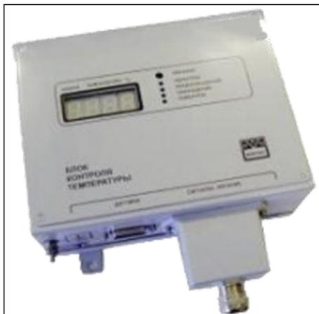
БКТ-2 предназначен для контроля и поочередной индикации температуры трех обмоток и магнитопровода сухих трансформаторов путем преобразования сигналов от четырех датчиков температуры в электрический сигнал, сигнализации о выходе температуры контролируемых точек за пределы заданных значений, сигнализации обрыва и короткого замыкания датчиков, сигнализации пропадания первичного питания.
