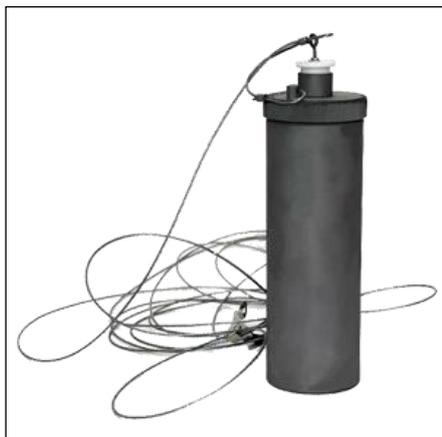
Переносной пробоотборник ПЭ-1640 предназначен для отбора проб нефти и масел из транспортируемых цистерн и стационарных резервуаров. Производит отбор пробы с любого уровня резервуара.
