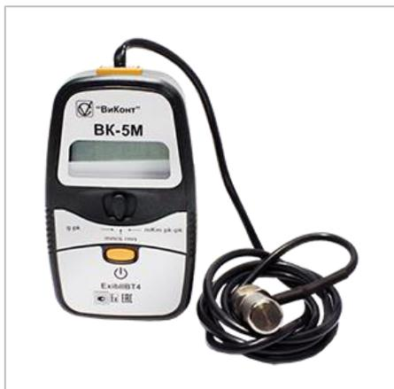
Портативный виброметр ВК-5 предназначен для измерения в реальном масштабе времени амплитуды виброускорения, среднего квадратического значения (СКЗ) виброскорости и размаха виброперемещения.
