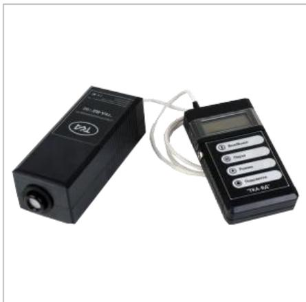
Прибор предназначен для измерения координат цветности и коррелированной цветовой температуры источников света в международной колориметрической системе МКО 1931г. и 1976 г. в плоскости освещённости, создаваемой нормально расположенными источниками.
