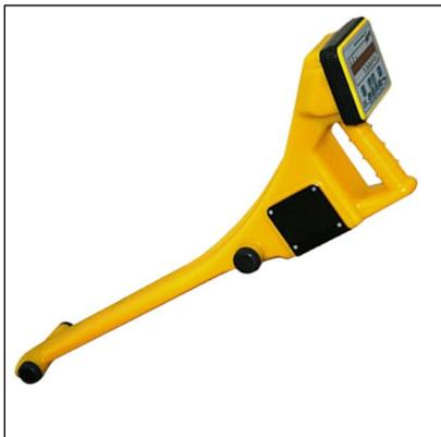
Трассопоисковый приемник многочастотный **ТМ-6** (трассоискатель) служит для бесконтактного определения положения и глубины залегания подземных металлических трубопроводов и кабелей и иных протяжённых подземных коммуникаций. Приемник может использоваться как совместно с генератором ТГ-ХХ, так и автономно - для обнаружения трубопроводов, находящихся под напряжением катодной защиты, действующих силовых и связных кабелей.
