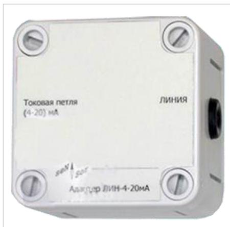
Адаптеры ЛИН-4-20мА предназначены для преобразования значения измеряемого параметра датчика СИ СЕНС в сигнал токовой петли 4-20 мА.
