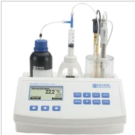
Автоматический минититратор HI-84529-02 предназначен для определения уровня титруемой кислотности в молочных продуктах на основе кислотно-основного способа титрования
