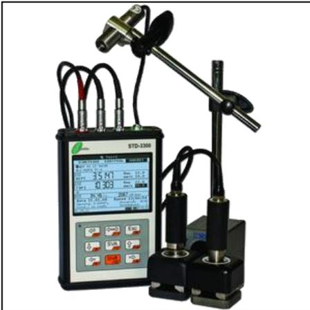
Виброанализатор STD-3300 - портативный двухканальный быстродействующий анализатор, позволяющий собирать, обрабатывать и анализировать данные по двум каналам одновременно, с возможностью одно и двух плоскостной балансировки роторов в собственных опорах. Предназначен для полноценного контроля технического состояния и диагностики роторного оборудования.
