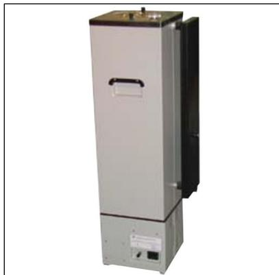
Термостат паровой ТП-2 служит для поверки термометров сопротивления при температуре кипения воды в лабораторных условиях.
