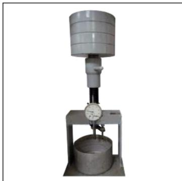
Прибор ПЛА-2 предназначен для определения глубины вдавливания штампа при испытаниях литых асфальтобетонных смесей по ГОСТу Р 54400-2011.
