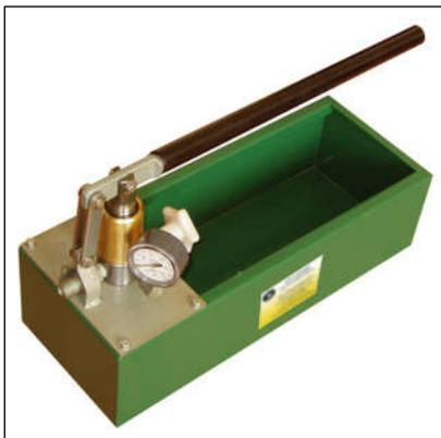
Ручной насос «НР-60» (ТУ 4141-006-02566510-2006) предназначен для проверки на герметичность котлов, систем отопления и различных емкостей испытательным давлением до 60 атм. (6 МПа). Благодаря универсальности применения, удобному расположению приборов, изготовлению основных деталей из коррозионностойких материалов, опрессовщик незаменим для работы в службах коммунального хозяйства.
