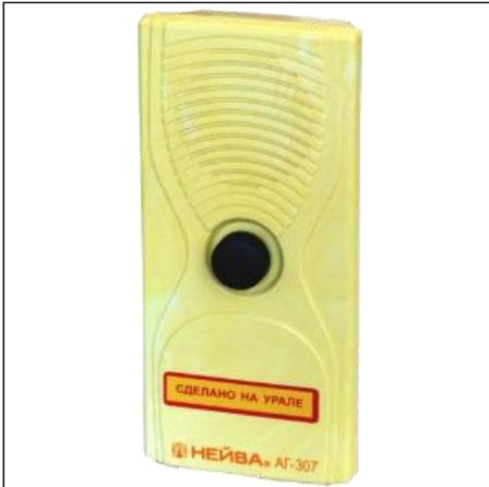
Громкоговоритель абонентский «Нейва АГ-307» является однопрограммным и предназначен для воспроизведения передач низкочастотного канала сети проводного вещания.
