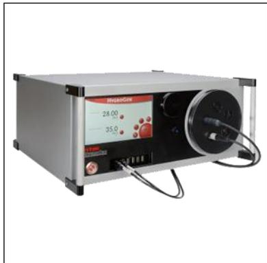
Генератор влажного воздуха динамический HygroGen предназначен для воспроизведения задаваемых значений относительной влажности, температуры и температуры точки росы в паровоздушных смесях, применяемых для градуировки и поверки гигрометров и проведения научных исследований.
