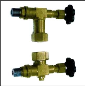
12с13бк - запорное устройство указателя уровня кранового типа. Диаметр условного прохода 20 мм, условное давление 40 кгс/см<sup>2</sup>, температура среды от -40 до +250 °С. Материал - углеродистая сталь.
